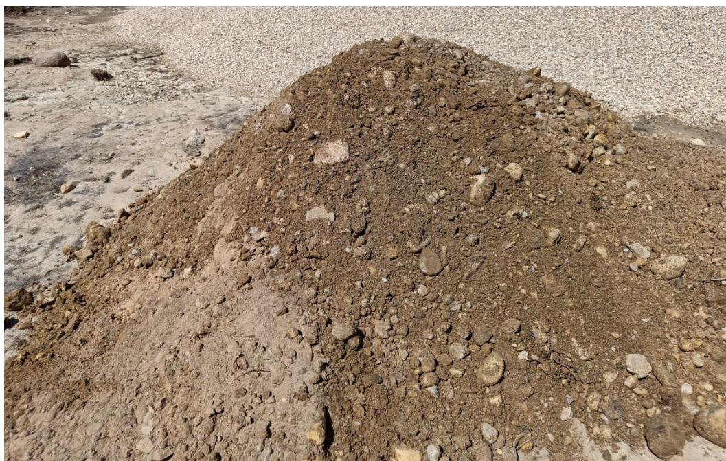
Foto 15. K-8-24 kaevandi intervallist 0,2-1,0 m väljatõstetud materjal
