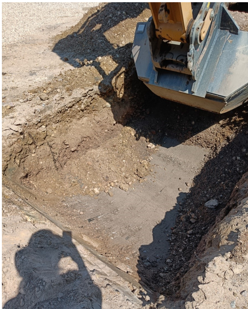
Foto 14. K-8-24 kaevandi sein (peen kruus) intervallis 0,0–1,0 m, põhjas liiva kiht
