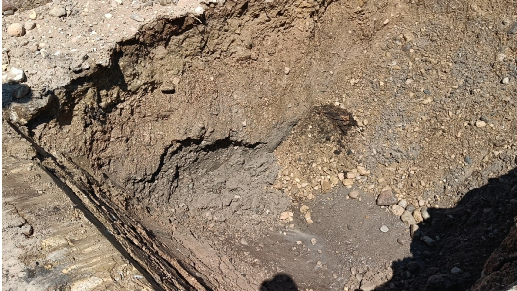
Foto 13. K-7-24 kaevandi sein intervallis 0,0–2,0 m: alumises osas puhas liiva kiht
