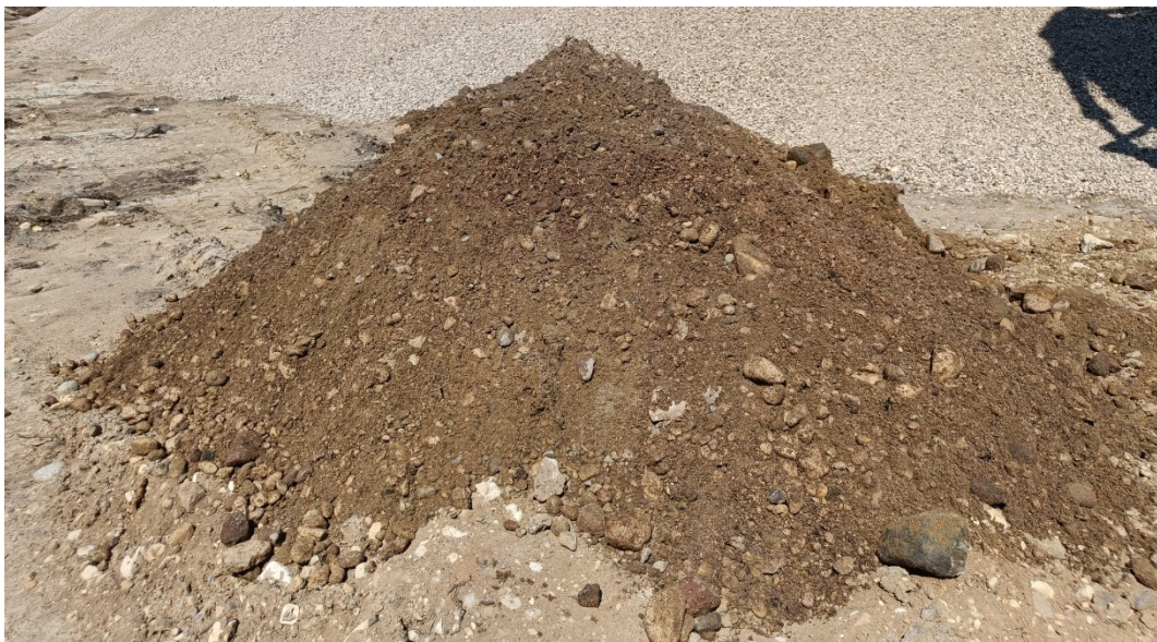
Foto 12. K-7-24 kaevandi intervallist 0,2-0,8 m väljatõstetud materjal
