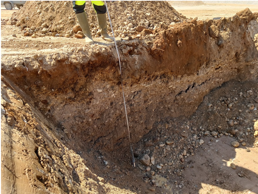
Foto 8. K-5-24 kaevandi sein intervallis 0,0–1,8 m, põhjas liiva kiht
